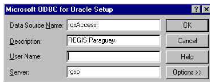
Figura 7: Definición de la conexión de ODBC – Configuración
