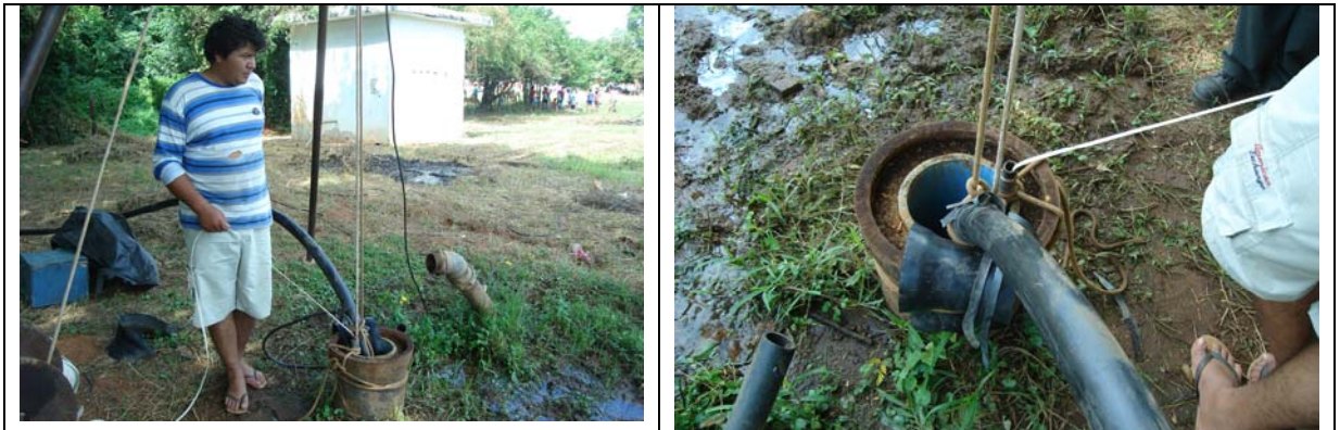
Fig. 15: Fotos Ensayo de Bombeo ESSAP M.R.A.
