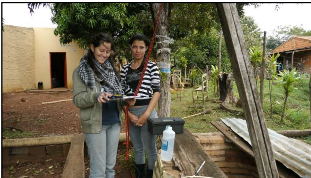
Itauguá – Relevamiento de datos de pozos someros, registro de Nivel del agua, Conductividad eléctrica, pH y temperatura.
