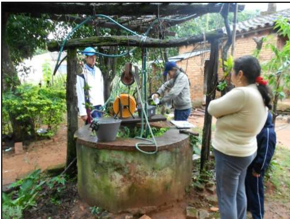
San Juan Bautista – Medición del nivel del agua, registro de la conductividad eléctrica y el pH en pozos someros
