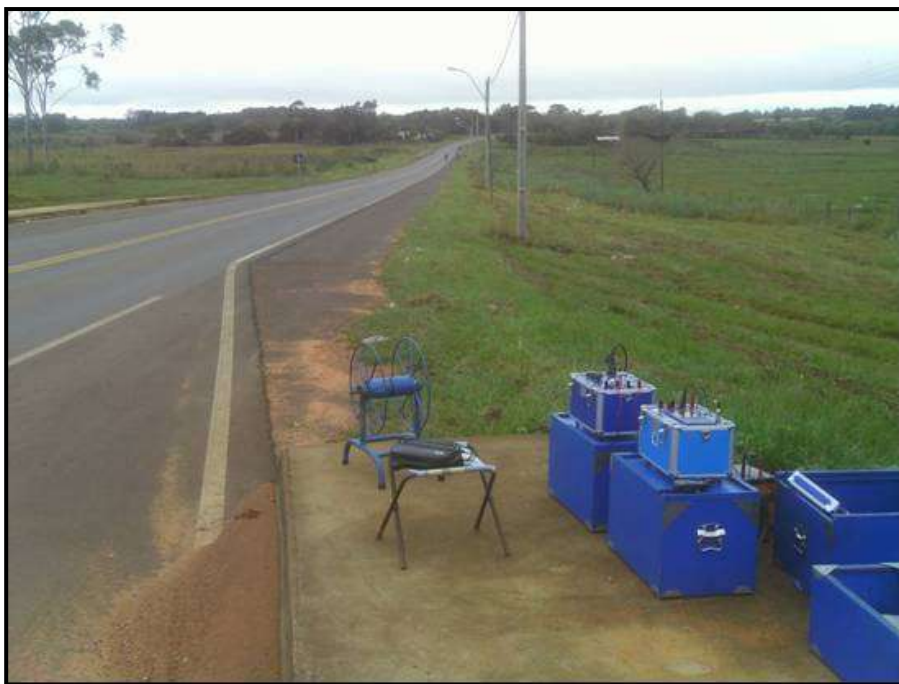
San Juan Bautista – Ejecución de la línea de Tomografía Geoeléctrica N° 3 – Barrio Ynambuy
