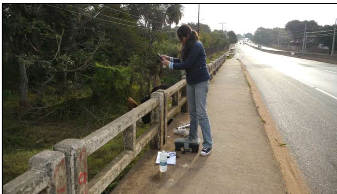
Itauguá – Relevamiento de datos de pozos someros, registro de Nivel del agua, Conductividad eléctrica, pH y temperatura.
