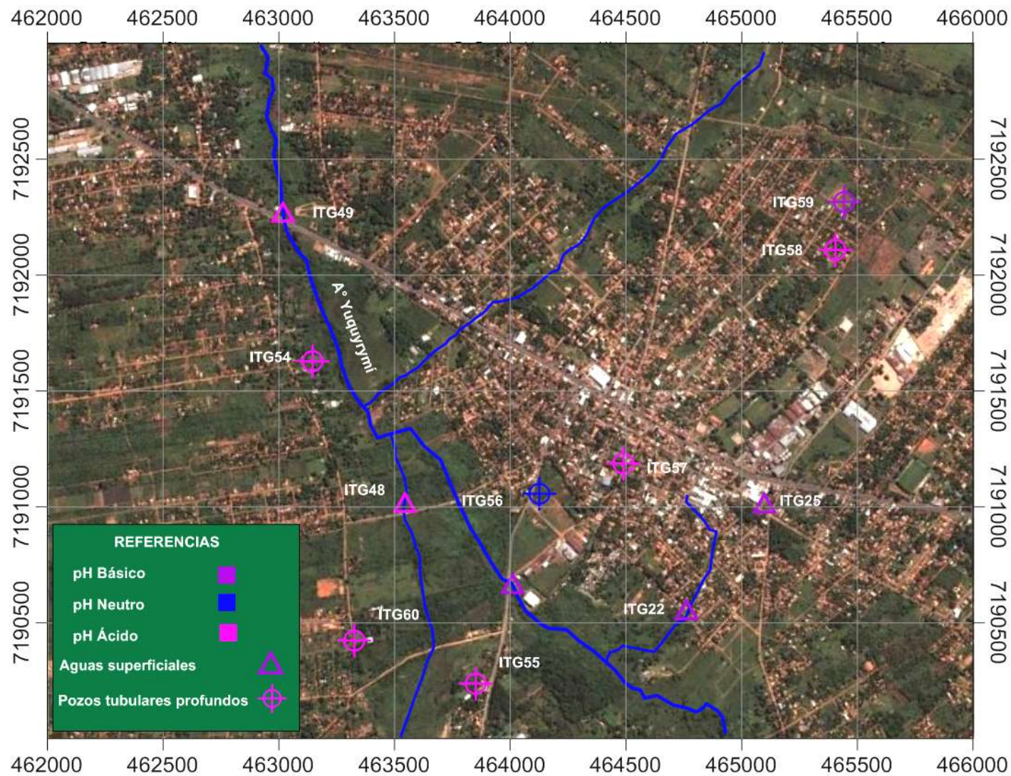
Fig. 40. Itaguá - Distribución del pH en las aguas superficiales y los pozos tubulares profundos
