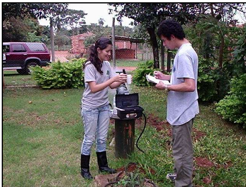
Itauguá – Registro de la Conductividad Eléctrica, pH, Temperatura y toma de muestra para análisis de agua de pozos tubulares profundos (Pozo 15 de la Junta de Saneamiento de Itauguá)
