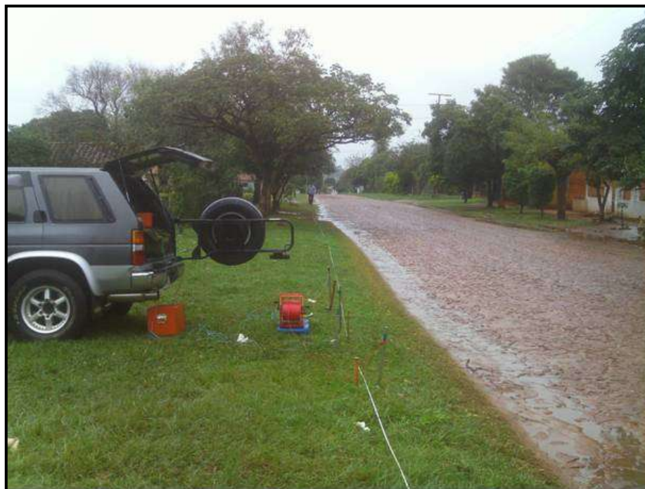
San Juan Bautista – Ejecución del Sondeo Eléctrico Vertical N° 20, sector de Villa Esperanza
