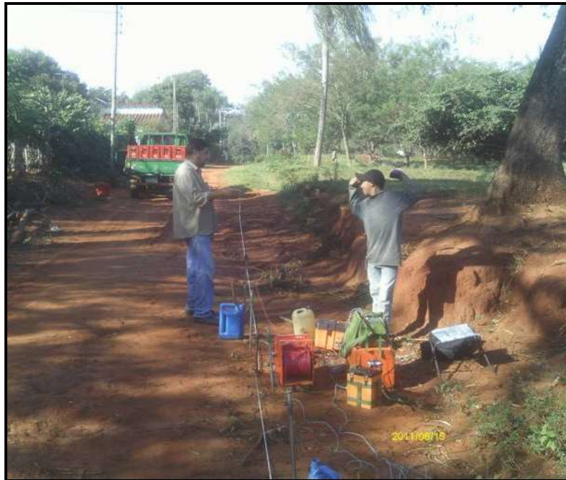
Itauguá – Ejecución del Sondeo Eléctrico Vertical N° 10
