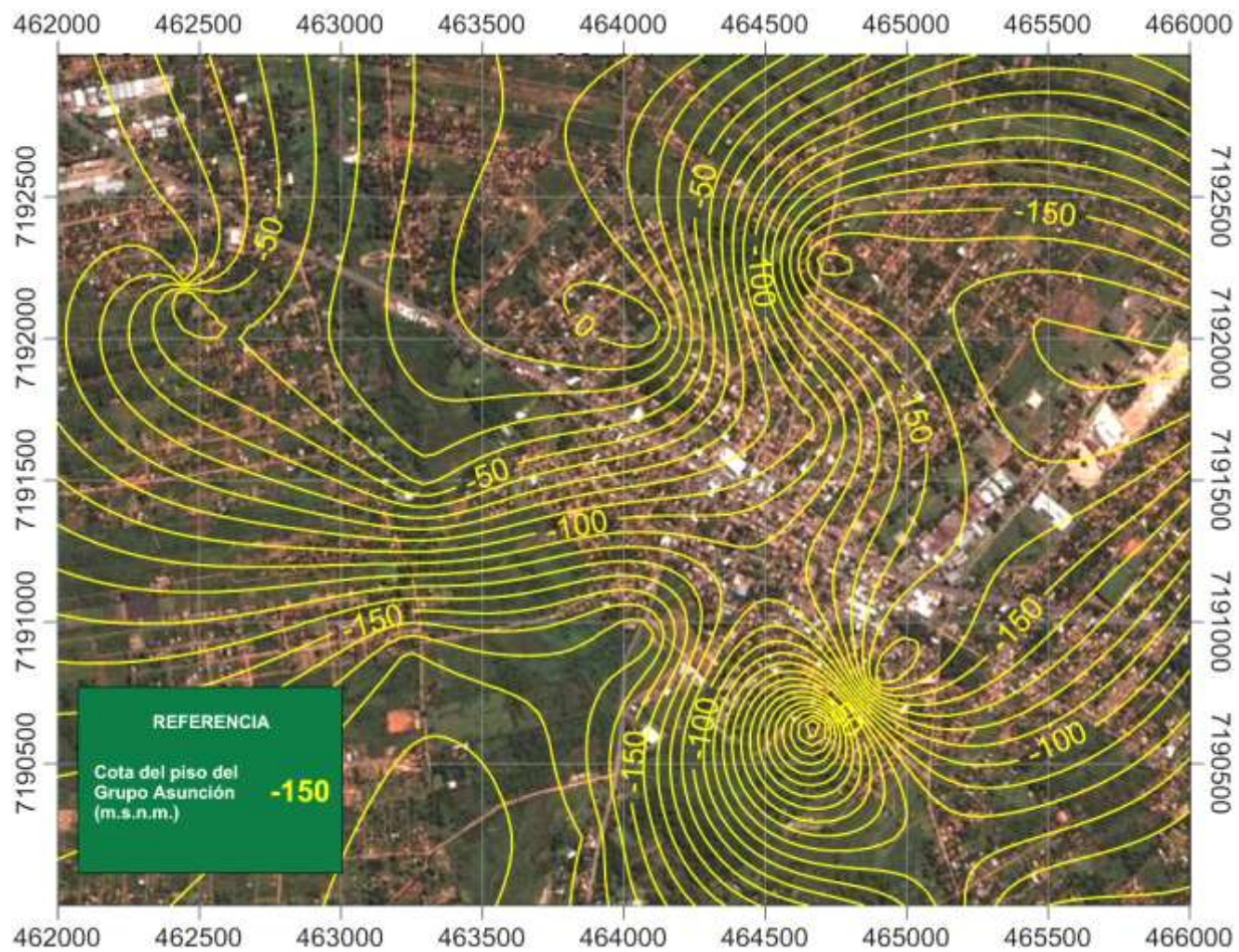
Fig. 31. Itauguá - Distribución de la cota del piso del Grupo Asunción (Acuífero Patiño) y techo de rocas del paleozoico.
