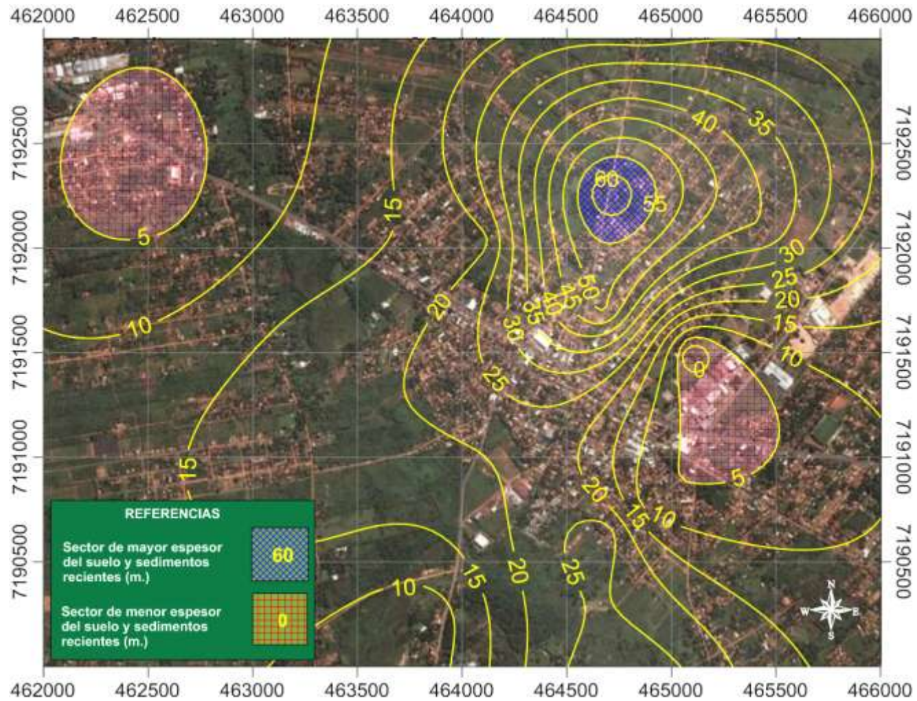
Fig. 29. Itaiguá - Distribución del espesor de la Capa N° 1 – Suelo y sedimentos recientes
