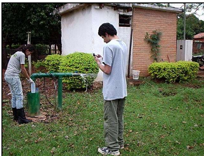
Itauguá – Registro de la Conductividad Eléctrica, pH, Temperatura y toma de muestra para análisis de agua de pozos tubulares profundos (Pozo 8 de la Junta de Saneamiento de Itauguá)
