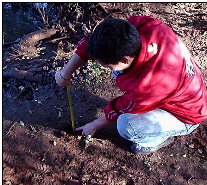
Itauguá – Medición del nivel del agua en el Sondeo Mecánico N° 1
