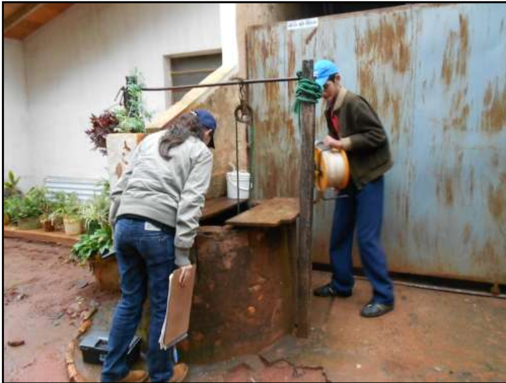
San Juan Bautista – Medición del nivel del agua en pozos someros
