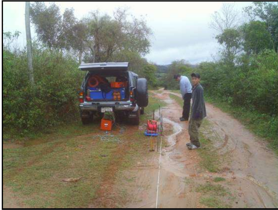
San Juan Bautista – Ejecución del Sondeo Eléctrico Vertical N° 19, sector de Yataí
